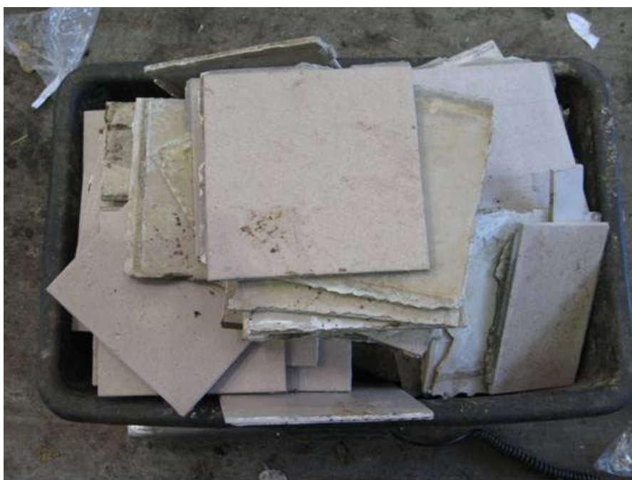
Foto 4: Über den Restabfallbehälter entsorgte Fliesen (Frostschaden)
